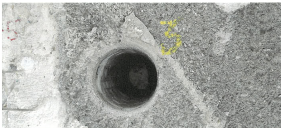
Obr. 14: Pohled na sondu po odběru jádrového vývrtnu 3, která byla provedena v konstrukci ŽB věnce – zkušební plocha Z2.
